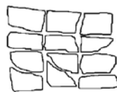
Junta corrida (incorrecto)
